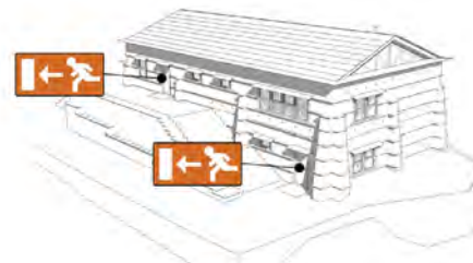
Double sortie pour assurer une évacuation rapide des occupants.
