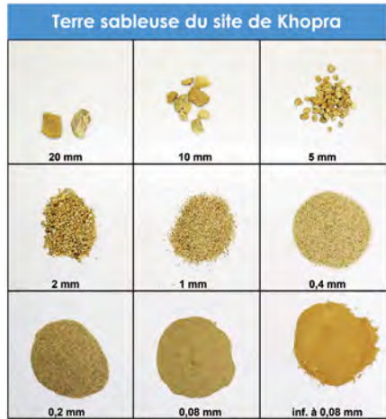
Analyse granulométrique par tamisage.
