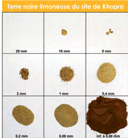
Analyse granulométrique par tamisage.
