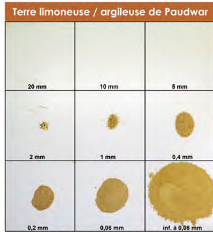
Analyse granulométrique par tamisage.
