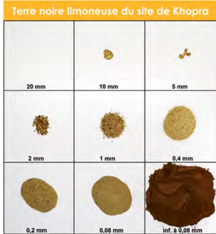
Analyse granulométrique par tamisage.
