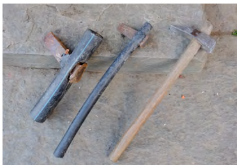
Les outils du maçon : tuktuke et chhinu maintenus à l'aide de tuyaux en PVC.
