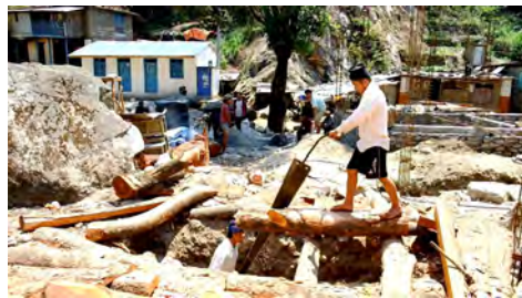
Tronc de bois en train d'être découpé manuellement à l'aide d'une scie passe partout.
