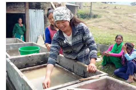
Préparation d'une feuille de papier en répartissant la pulpe de lokta dans un cadre en bois.
