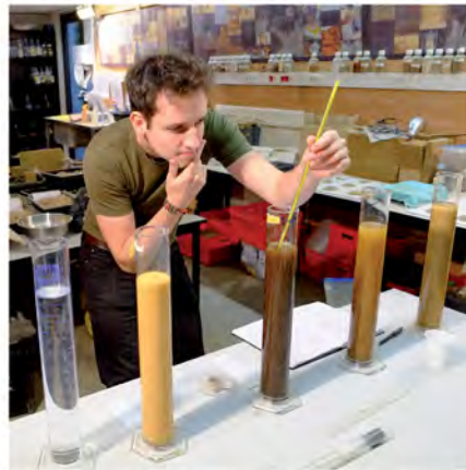
Jules Guerin en train de réaliser une analyse granulométrique par sédimentation.
