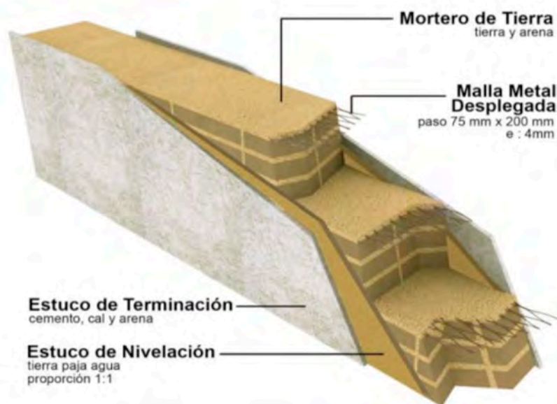
System de renforcement avec des maillages métalliques intégré dans le mur chaque trois adobes. Maria Elena, nord du Chili. Source : SurTierra
