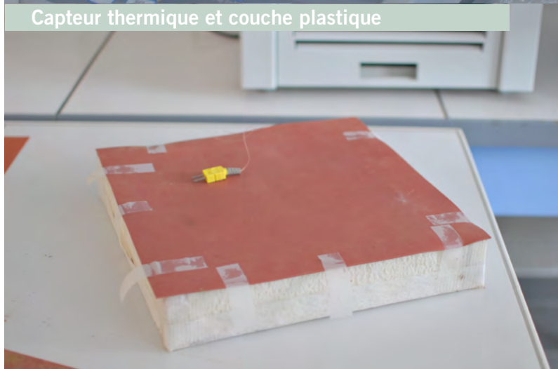
Détail machine HFM 436 Lambda NETZSCH
