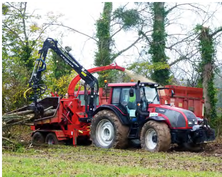
Machine pour couper et broyer sur place | STEVE
