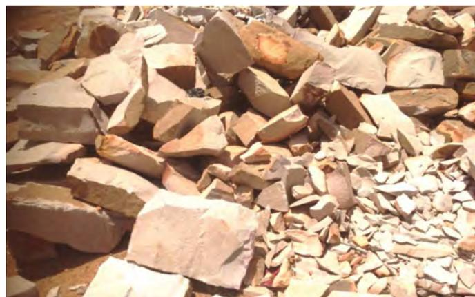
\_Le gravier rouge est extrait également dans le fleuve Niger à Koréomé, Transporté dans la ville par les pick up 4\*4 et vendu par m3. Il se présente moins propre et d'une granulométrie plus fine que le blanc. Les grains varient entre 1 cm et 2 mm. Il est plus utilisé dans les cas d'auto-construction du fait de son coût plus abordable.
