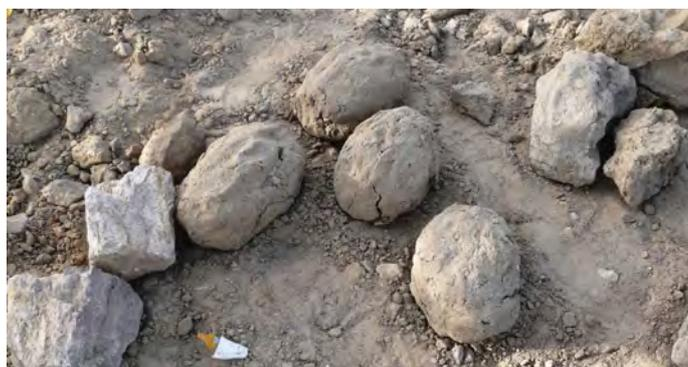
Les koïra ferrey sont les tous premiers blocs utilisés à l'avènement de la construction en terre crue à Tombouctou. Ils sont constitués d'un mélange de terre argileuse et de fibre végétale ou de la terre avec du sable, et dont une forme ovale proche de celle d'un demi-œuf, moulés à la main et séchés au soleil. Les dimensions sont plus ou moins irrégulières avec un diamètre de 10 cm et une longueur de 15 cm.
