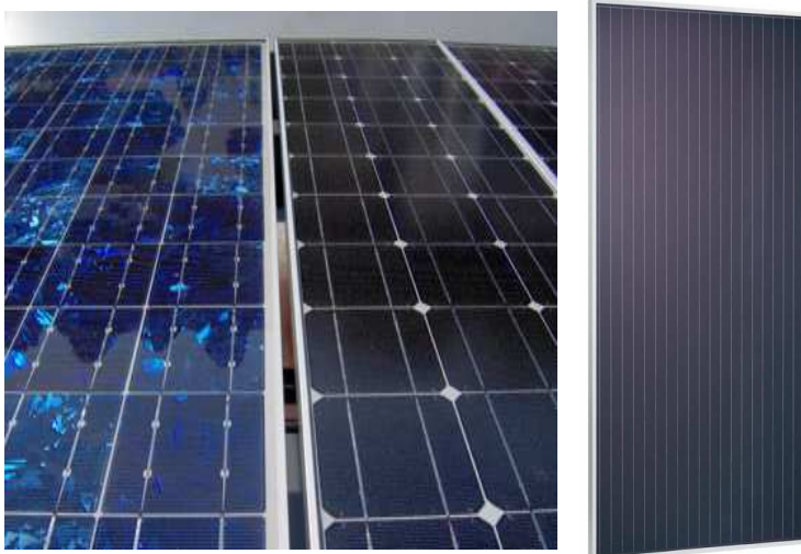
Figure 3- photographie de panneaux photovoltaïque : polycristallin, monocristallin et amorphe
