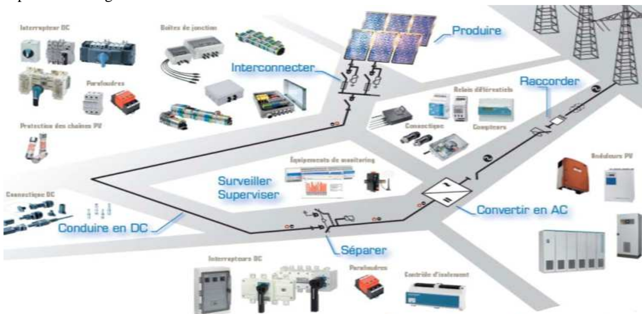
Figure 4- Schéma de représentation des composants et fonctions d'un système photovoltaïque (Source : Gimélec)
