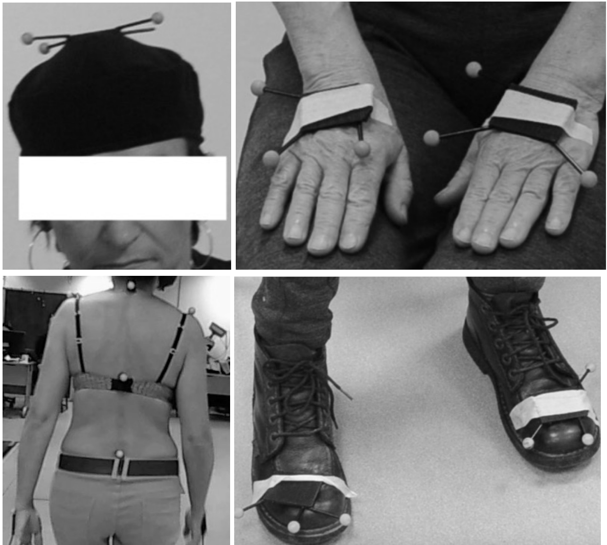
Figure 5: Disposition des marqueurs passifs réfléchissants pour l'analyse quantifiée de la marche
