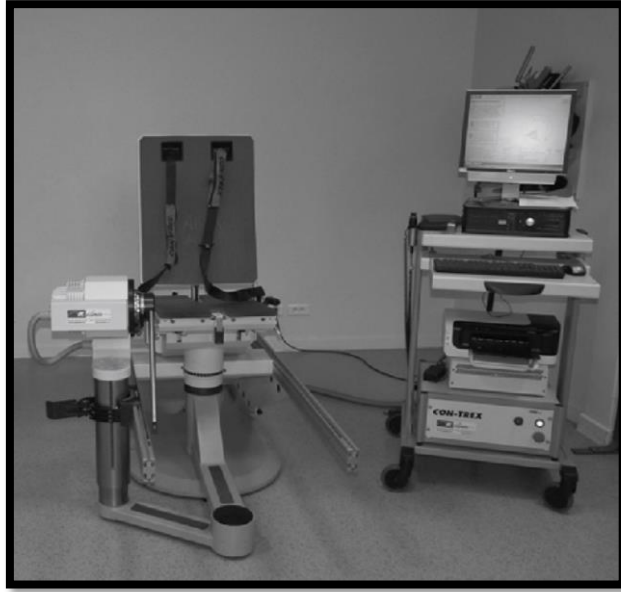
Figure 33: appareil de mesure isocinétique
