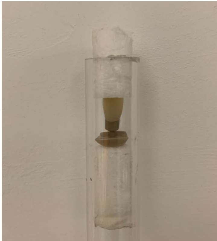
Figure 20 : Photographie d'un échantillon 3 sur le maître modèle prêt pour l'acquisition par m-CT.
