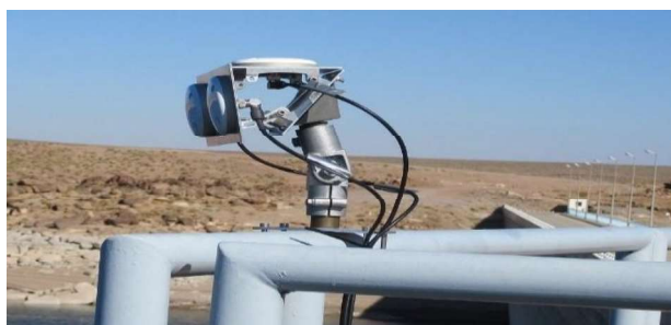
Figure I-9 : Récepteur GNSS-R utilisé dans le projet PMARS. (PMARS projet, GFZ)
