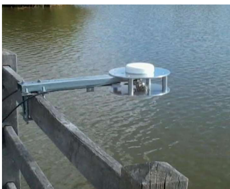
Figure I-5 : Récepteur GNSS-R à double antennes (Lestarquit, 2016)
