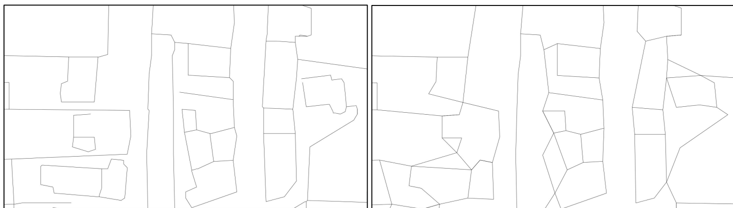
Figure 5 Choix d'un seuil trop important pour la fonction snap : avant/après
