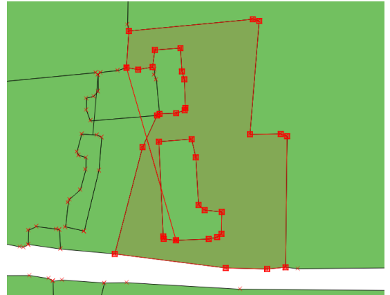
Figure 8 Problème de polygone inclus dans un autre lié à la labellisation
