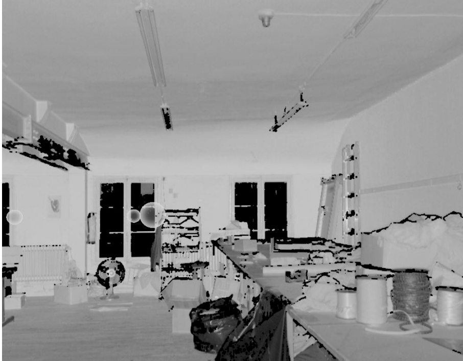
Figure 23 : visualisation du nuage de points d'une pièce où le plafond est, d'une part, incliné suivant une pente qui part du mur de droite jusqu'à la poutre à gauche et, d'autre part arrondi pour se raccorder au mur du fond au-dessus des fenêtres.
