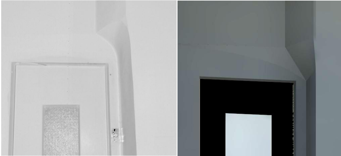
Figure 20 : formes de mur complexes visualisées dans le nuage de points (à gauche) et modélisées dans Revit (à droite).
