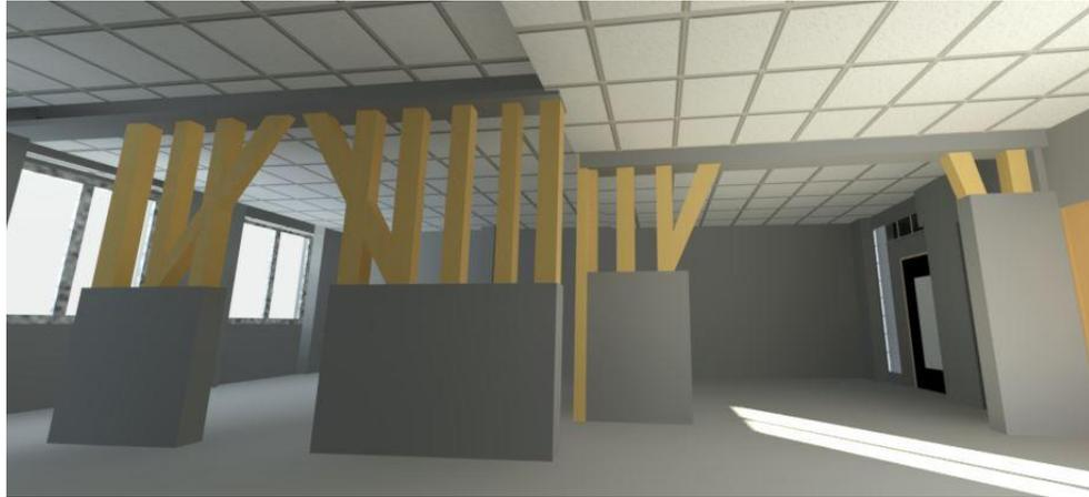
Figure 26 : modélisation d'un ensemble de poutres horizontales, verticales et obliques dans Revit.
