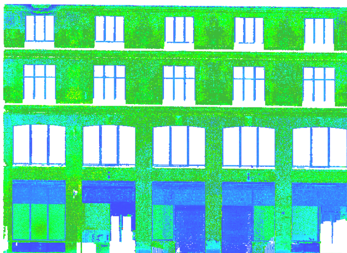
Illustration 21: Nuage de points n°1 colorisés par la valeur de l'intensité de retour de l'impulsion laser
