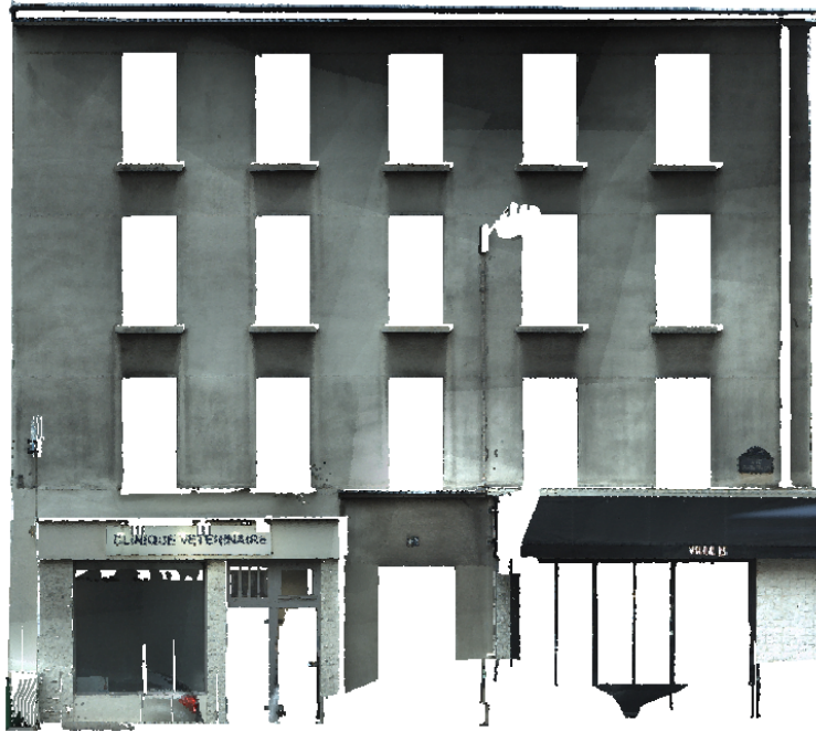
Illustration 22: Nuage de points n°2 colorisés par les couleurs réelles, capturées par numérisation grâce à la caméra intégrée au scanner.
