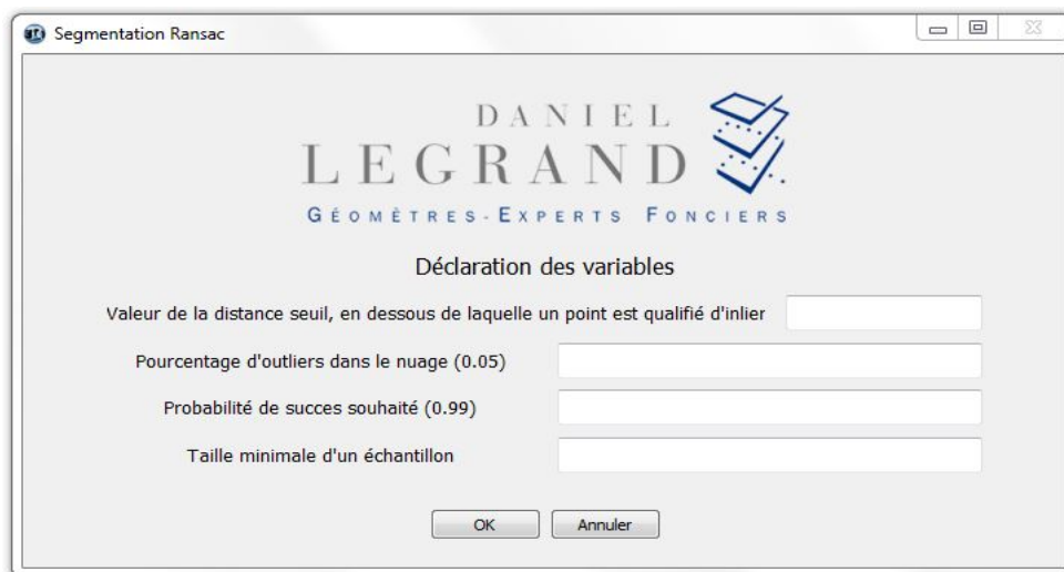
Illustration 30: Boîte de dialogue de la segmentation d'un nuage selon l'algorithme RANSAC développé sous le logiciel 3DRESHAPER.
