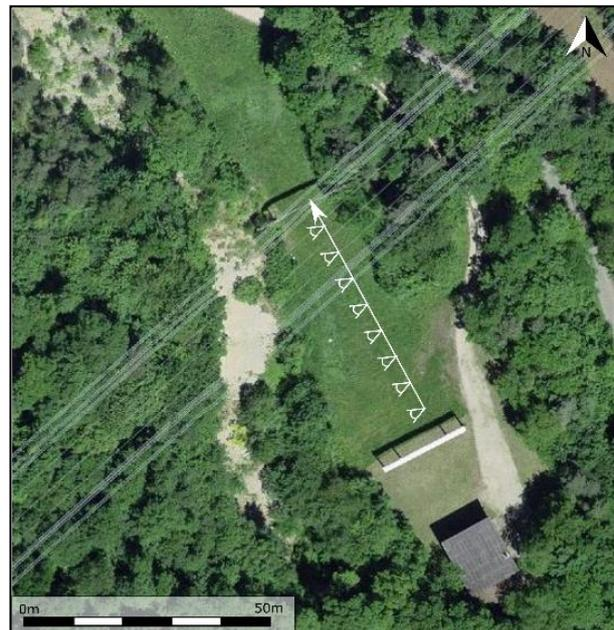
Figure 18 : Configuration de photogrammétrie terrestre de manière classique
