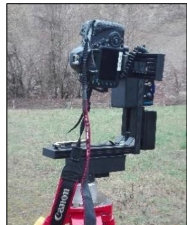
Figure 21 : Bras motorisé Rodéon Pixpert monté sur trépied
