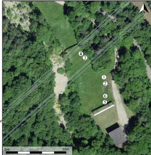
Figure 19 : Configuration de photogrammétrie terrestre en mode "Panoramique"
