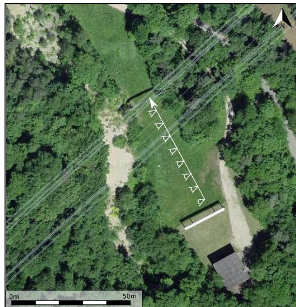
Figure 18 : Configuration de photogrammétrie terrestre de manière classique
