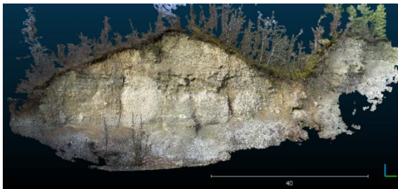
Figure 23 : Nuage de points Albris 2018 généré sur Pix4D 157 photos, 14 millions de points Cf. Nuage 2, Annexe 4 et 6
