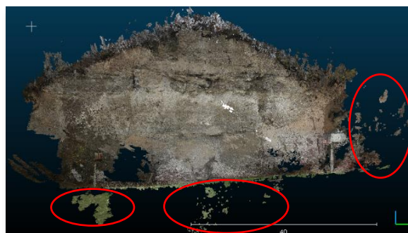
Figure 26 : Nuage de points Rodéon 6 stations généré sur Pix4D 19 Photos, 36 millions de points. Cf. Nuage 8, Annexe 4 et 6
