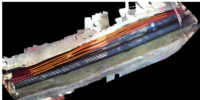
Figure 20 Superposition du levé de contrôle sur l'orthoimage (issue de Pix4D)
