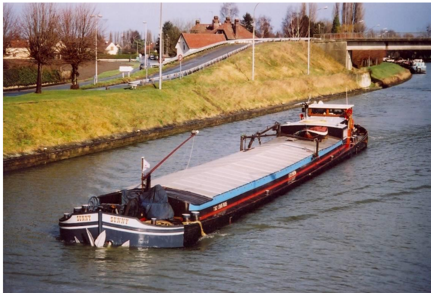
Figure 1 - Automoteur, péniche de type Freycinet. Source : http://bab.viabloga.com
