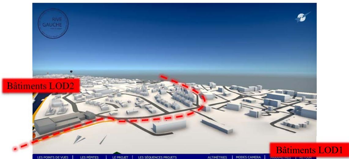
Figure 15 : visualisation des bâtiments LOD 1 et des bâtiments LOD 2
