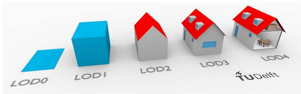
Figure 3 : Les différents niveaux (LOD) de détails en CityGML (Source : oslandia.github.io)
