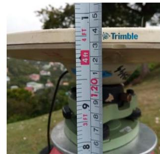
Figure 2 : Photographie d'une mesure de hauteur d'antenne à l'aide d'un ruban
