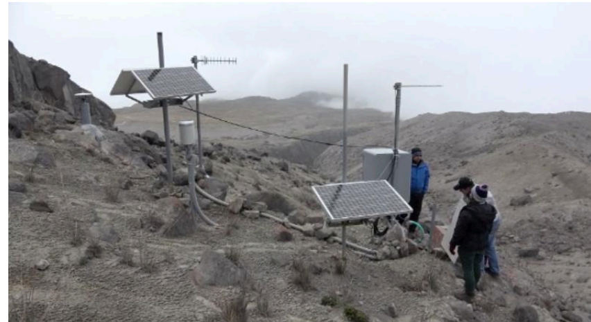
Figure 18: Station de mesure sismique et de déformation de Nereidas (M. Le Cam 2018).
