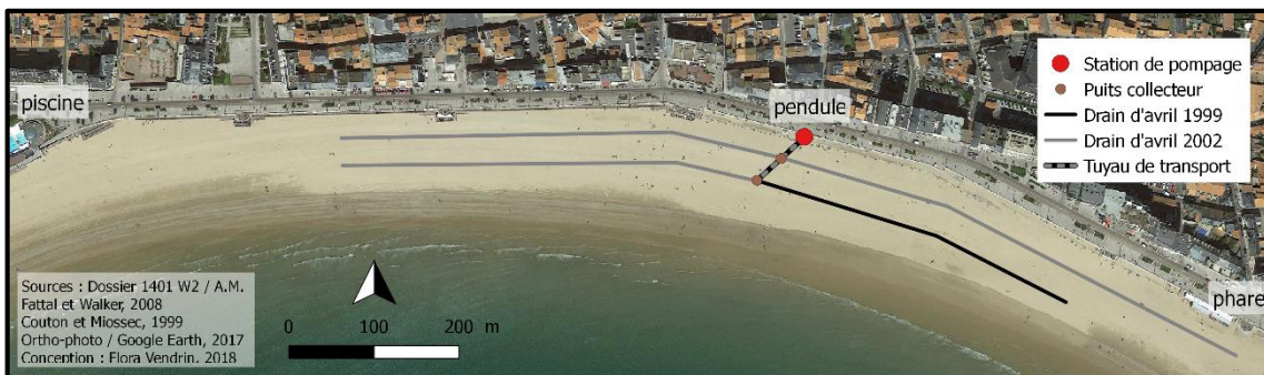
Figure 20 : Situation des drains Ecoplage sur La Grande Plage des Sables-d'Olonne
