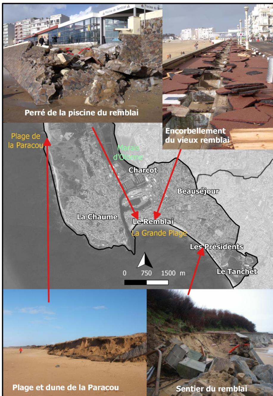
Figure 23 : Quelques dégâts de la tempête Xynthia de février 2010 sur la côte sablaise (source : DST des Sables-d'Olonne, conception F.Vendrin 2018)
