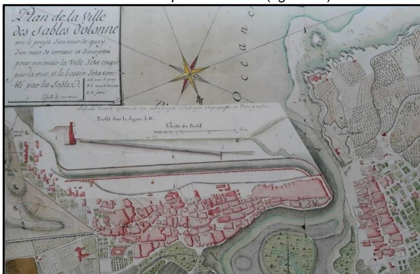
Figure 10 : Plan de 1750 du second mur de protection contre la submersion marine dont les travaux débutent en 1751 (source : Tranchant, 2012)
