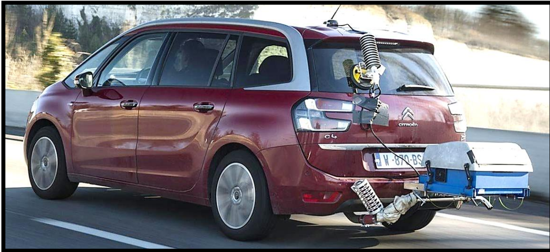
Figure 3-27 : installation des PEMS pour un test RDE (454)
