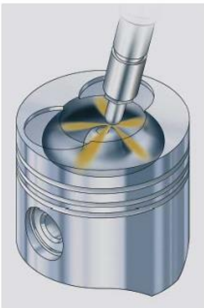
Figure 1-3 : spray de gazole et hétérogénéité du milieu à l'intérieur de la chambre de combustion juste avant l'auto-inflammation du mélange comprimé (moteur à injection directe) (44).
