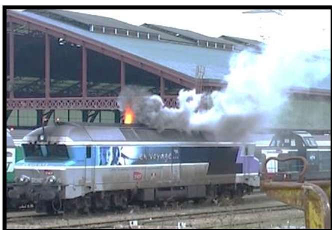
Figure 2-6 : phase de démarrage à froid d'une locomotive CC 72100 SNCF pendant laquelle l'émission diesel est massive
