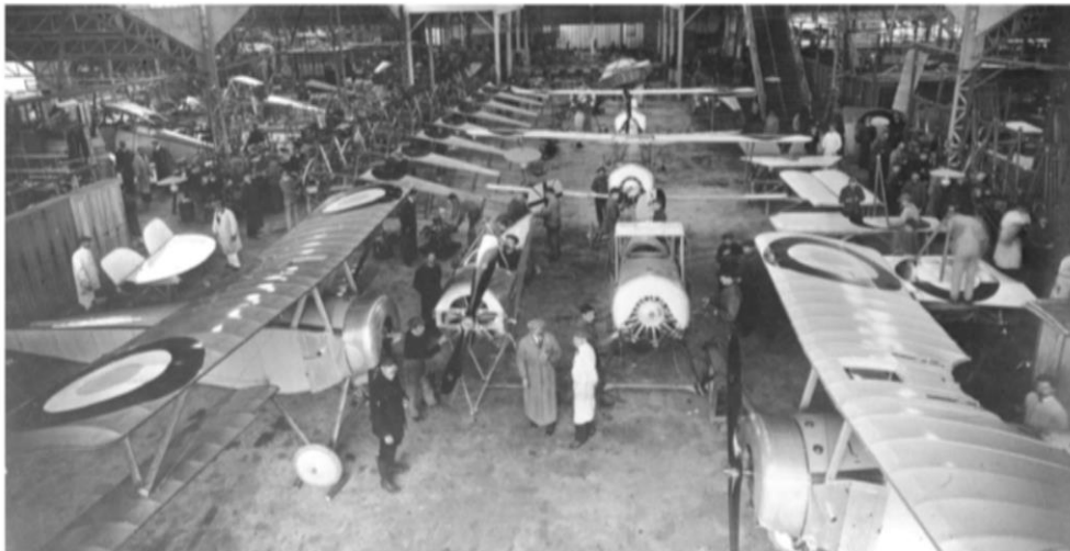
Usine Nieuport (Issy-les-Moulineaux ?) : chaîne d'assemblage de Nieuport XI. Collections du Service historique de la Défense, photothèque, cote B 87-0444. © Coll. service historique de la Défense, Vincennes
