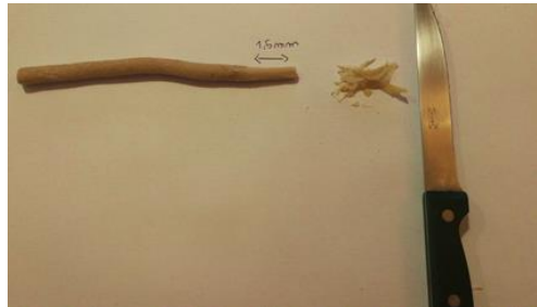
Figure 30 : Extrémité effilochée sur 1,5 cm
