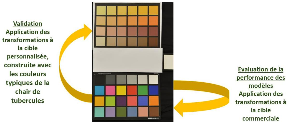
Figure 13 : Cible colorimétrique commercial de calibration à droite de l'image et cible personnalisée de validation à gauche de l'image
