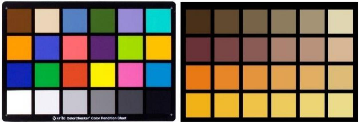
Figure 8 : Cible colorimétrique commercial de calibration à droite de l'image et cible personnalisée de validation à gauche de l'image
