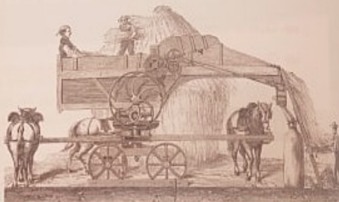
Doc. 4 Une batteuse utilisant la force animale, 1881
