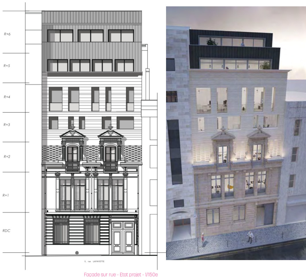
Figure 28 : Élévation et insertion du dernier AVP - 5 rue Lafayette
