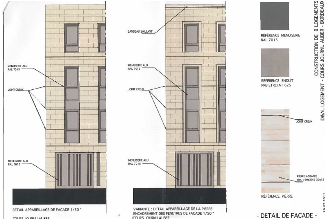
Figure 21 - Détails de façade du troisième AVP - 117 cours Journu Auber
