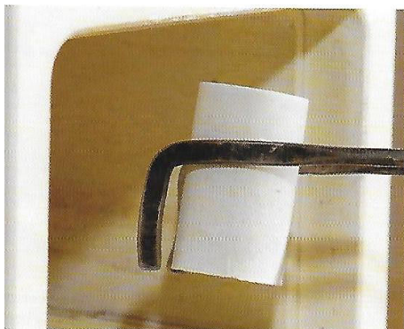
5. Après retrait du gabarit, du cylindre et du cône, le revêtement est mis au four de chauffe
