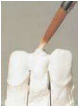
3. Montage de la barbotine sur le modèle positif unitaire coulé dans un plâtre spécial, enduit d'un abaisseur de tension superficielle
