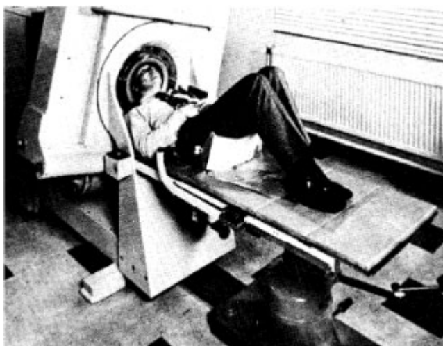
Illustration 8: Tomodensitomètre de Hounsfield, 1971.
