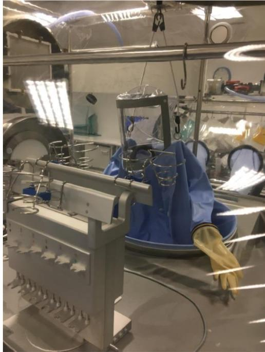
La fabrication des poches se fait à l'aide d'un automate de préparation (Medimix®) qui se trouve à l'intérieur de l'isolateur. 3 isolateurs satellites (Figure 7) permettent le transfert des matières premières (MP) nécessaires à la production au sein de l'isolateur principal.
