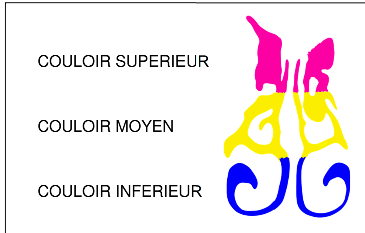
Figure 9 : Définition des couloirs inférieur, moyen et supérieur. Calcul dans chaque couloir de la vitesse, la température, et de la pression totale.
