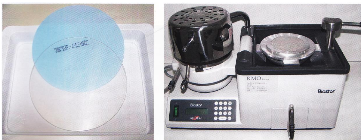
Figure 19 : Plaques thermoformables utilisées au cabinet et thermoformeuse Biostar®
