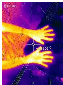
Image 8 : L'image thermique est prise de telle façon qu'on visualise le reste du corps du patient et le sol. Cet arrière-plan rend difficile la détection des zones d'intérêts par le logiciel GipsVision
