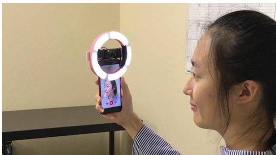
Figure 79 : Exemple d'application en cabinet dentaire : scan facial 3D, scan intra-oral avec caméra 3D. Les 2 fichiers ont été couplés pour reconstituer le massif oro-facial du patient en 3D. Documentation commerciale, source : bellus3D.com
