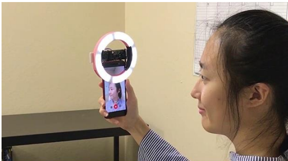
Figure 79 : Exemple d'application en cabinet dentaire : scan facial 3D, scan intra-oral avec caméra 3D. Les 2 fichiers ont été couplés pour reconstituer le massif oro-facial du patient en 3D. Documentation commerciale, source : bellus3D.com
