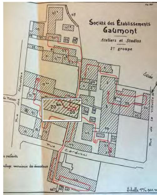
Fig. 21: Bâtiments des services de décolletage (n°20) et des tours (n°20 bis) agrandis sur le plan de visite, 1927
