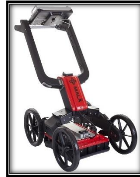
Figure 13 : Géoradar (Source : www.panatec-agua.com : consulté le 30/05/2019)
