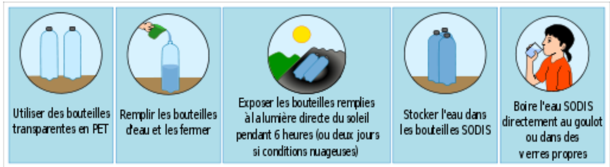
Figure n°9: Procédure de la méthode SODIS.
