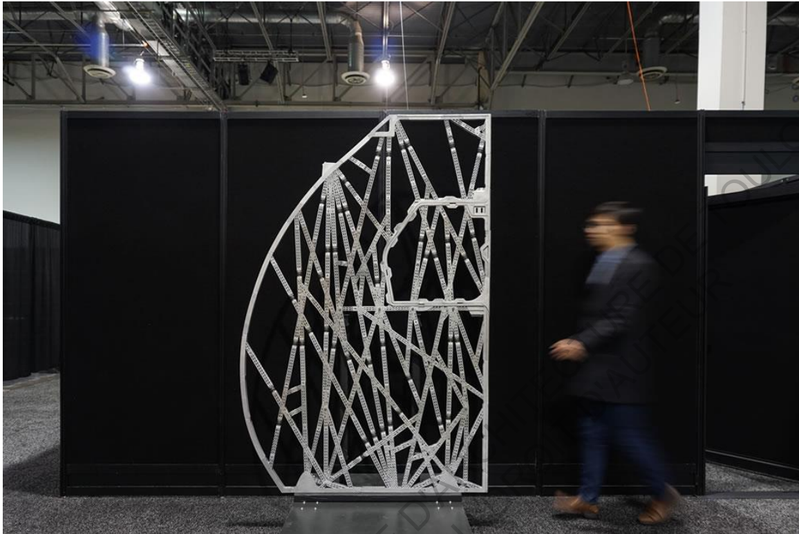
Figure 20 : Paroi de partition imprimée en 3D (Airbus / Autodesk Dreamcatcher)
