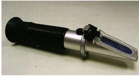
*Figure n°16* : Réfractomètre (Capdeville *et al.*, 2014).
