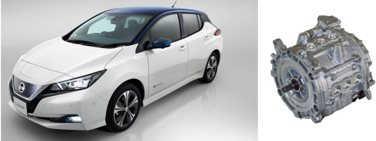
Figure 32 : La machine présentée est un moteur synchrone triphasé à aimant permanent à flux radial. Ce moteur développe une puissance mécanique nominale de 90 kW pour une vitesse nominale de 3000 tr/min [23].
