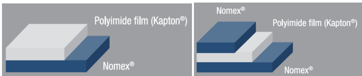
Figure 27 : Systèmes d'isolation du fond d'encoche avec du papier Nomex et du Kapton (système à deux couches / à trois couches) présentés par « Myoflex »
