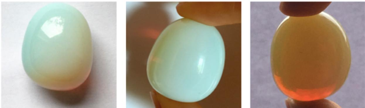
Fig. : 1.5. Observation de l'opalescence d'une opale artificielle
