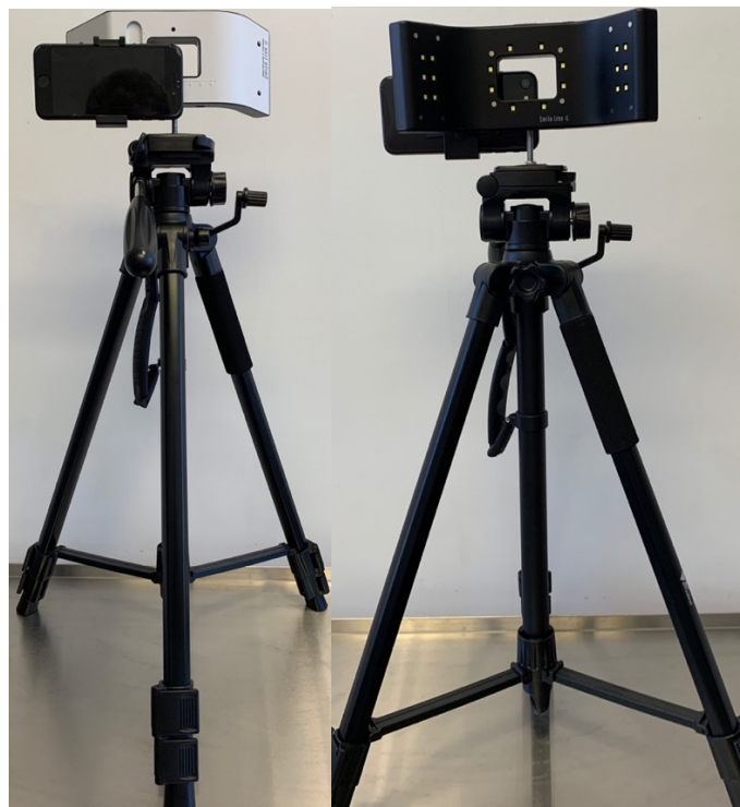
Figure 59 Montage du système d'acquisition vidéographique du point de vue du vidéographe et du sujet (document personnel)
