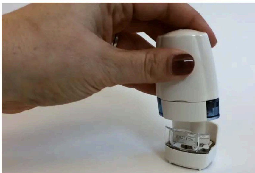
Figure 21 : Fixation de l'Add-On Sensor Propeller sur le Breezhaler®[84]
