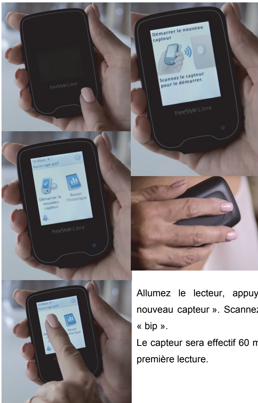
Illustration 8 : Pose du capteur Freestyle - démarrage du capteur (32)
